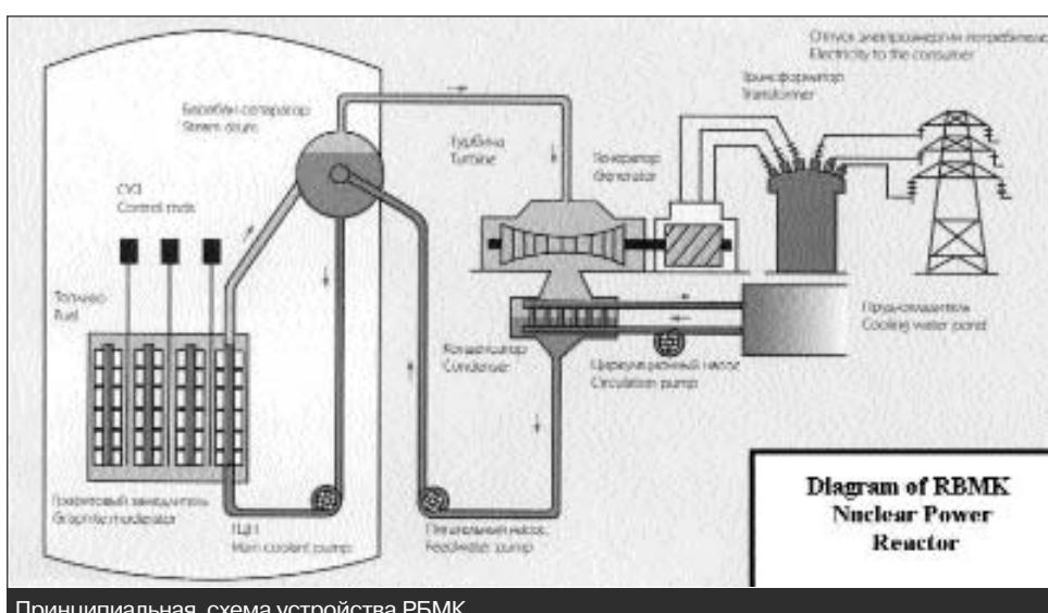
Принципиальная схема устройства РБМК
